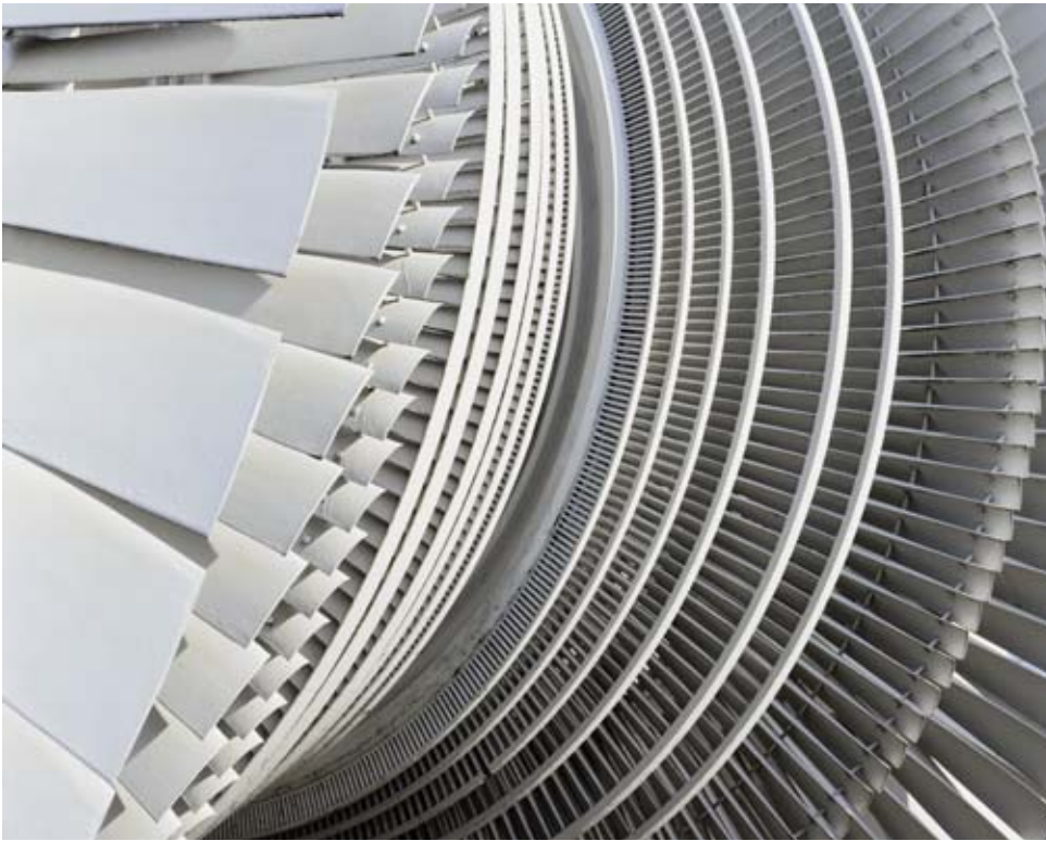
Höyryturbiini muuntaa lämpöenergiaa mekaaniseksi työksi. Kuvassa matalapaineturbiinin juoksupyörä.
